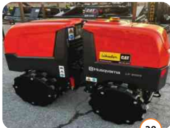
ROLO COMPACTADOR ARTICULADO HUSQVARNA LP 9505 CONTROLE REMOTO PARA VALA
