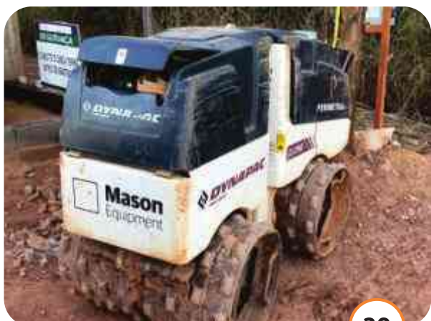
ROLO COMPACTADOR DYNAPAC CONTROLE REMOTO PARA VALA
