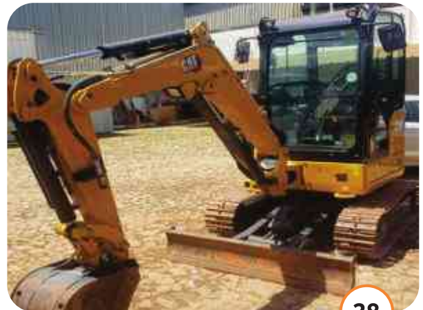
MINI ESCAVADEIRA CAT 302.7 POTÊNCIA LÍQUIDA 17.6 KW PROFUNDIDADE DE ESCAVAÇÃO DE 2.710 M
