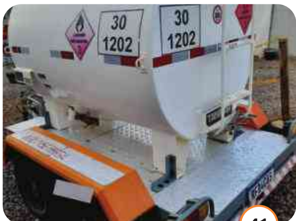
CARRETINHA COMBUSTÍVEL REBOQUE TQPP 2E TANQUE 2.000 L
